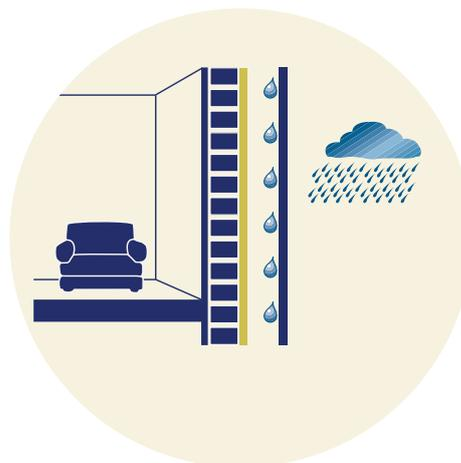
La lana minerale **URSA**, per la sua struttura e processo di fabbricazione, è idrorepellente (idrofoba) e pertanto non cattura l'umidità e non la trasmette ad altri strati dell'involucro.
