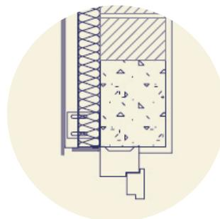
**2. Serramento sul filo esterno in continuità con l'isolante.** Raccomandiamo questa soluzione in quanto offre una minor superficie del ponte termico, e grazie alla continuità isolante-serramento se ne ottiene una correzione più efficace.
