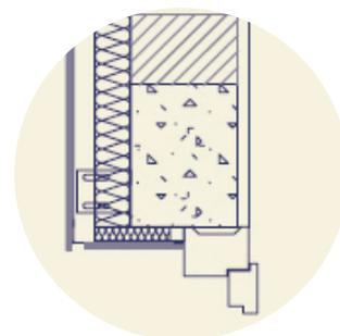
**1. Serramento sul filo interno con risvolto dell'isolante.** Con questa soluzione si ottiene una sufficiente correzione del ponte termico.
