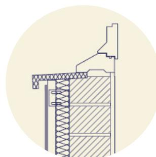
**1. Serramento sul filo interno con risvolto dell'isolante.** L'uscita della ventilazione sotto il davanzale deve avere un'apertura sempre superiore ai 20 mm, ed essere distaccata dallo stesso di almeno 10 mm in verticale.
